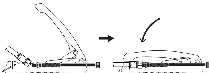
①ケーブルにコネクタを取り付け、挿入する。
