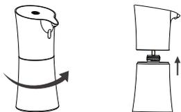
② 本体裏の電池カバーを反時計回りに回して開けます。
