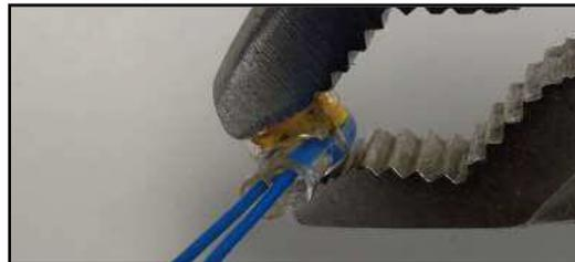
※コネクタ破損の恐れがある為、圧着の際はカバーが斜めにならないように均一に圧着してください。
