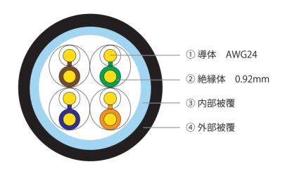
ケーブル印字:DS LAN CABLE CAT5E UTP 4×2×AWG24 TIA/EIA 568-C.2 SCBL XXXm XXXXXX -----長さ表示 製造番号 (1m間隔)
