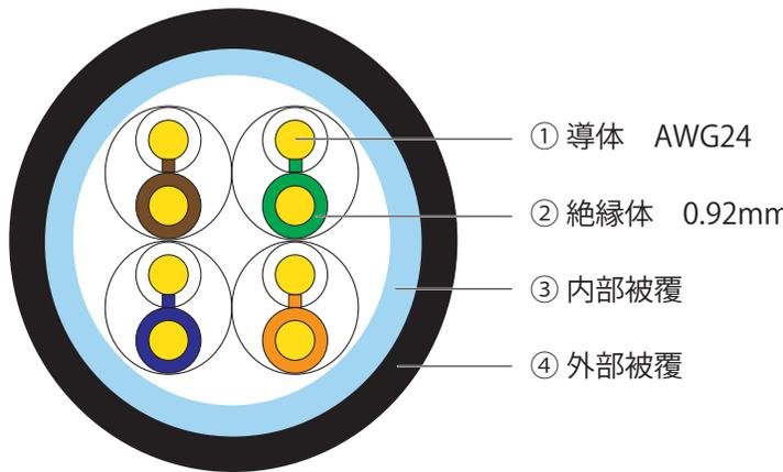
ケーブル印字：DS LAN CABLE CAT5E UTP 4×2×AWG24 TIA/EIA 568-C.2 SCBL XXXm XXXXXX
