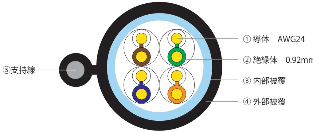
ケーブル印字：DS LAN CABLE CAT5E UTP 4×2×AWG24 TIA/EIA 568-C.2 SCBL XXXm XXXXXX
