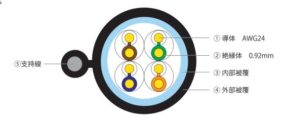
ケーブル印字:DS LAN CABLE CAT5E UTP 4×2×AWG24 TIA/EIA 568-C.2 SCBL XXXm XXXXXX 長さ表示 製造番号 (1m間隔)
