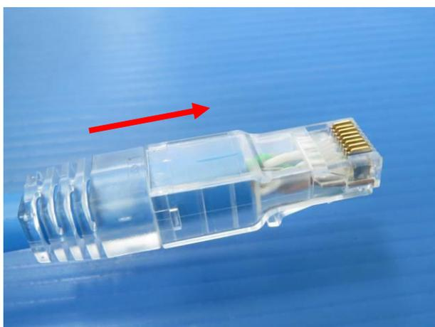
15. プラグ本体を指で固定し、絶縁体と外被がズレない様にケーブル全体をしっかりと固定して押し込む
